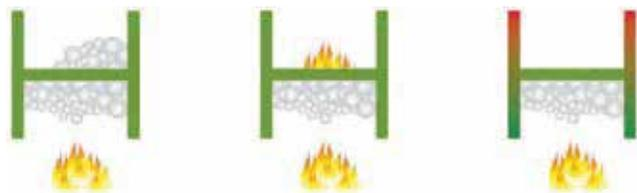
El fuego atacará cada uno de los elementos del sistema y el tiempo de retardación, medido en minutos, lo definirá la configuración de muro o plafón que elijas.
