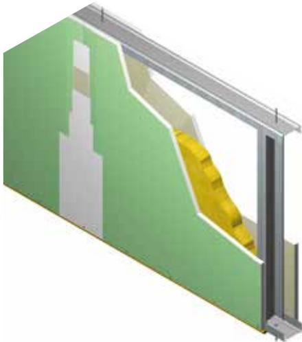
Aplicando un cordón de sellador de poliuretano PU Fix o PU Fix 40 de TekBond en a todo el perímetro de muros y plafones. Esto te ayudará a repeler la humedad, así como aportará en el control acústico.
