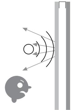
Acusti-K evita la reverberación del sonido al absorberlo, generando un mayor confort acústico. No olvides colocar un aislante de fibra de vidrio en el interior de tu muro para aumentar el nivel de absorción.
