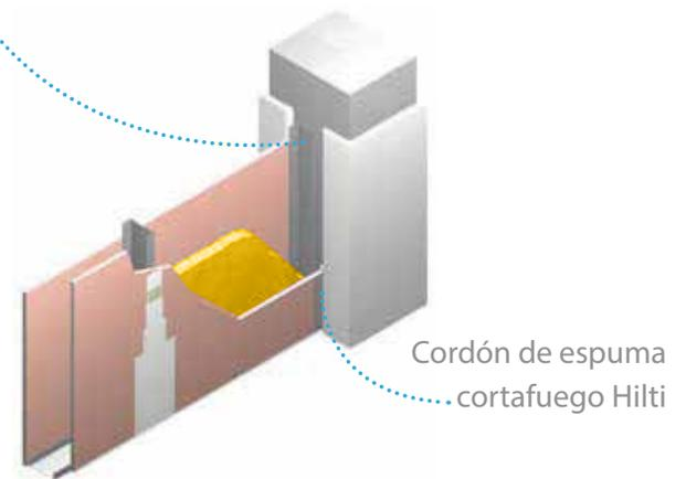
Corta la placa de yeso para la colocación de instalaciones y utiliza la espuma corta fuego Hilti , se expande aproximadamente 7 veces su volumen original y es 100% efectivo.
