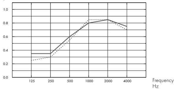
... Advance Baffle en filas, c600 mm, con ~1,4 baffles/m<sup>2</sup> de techo, 600 mm g.t.s.
