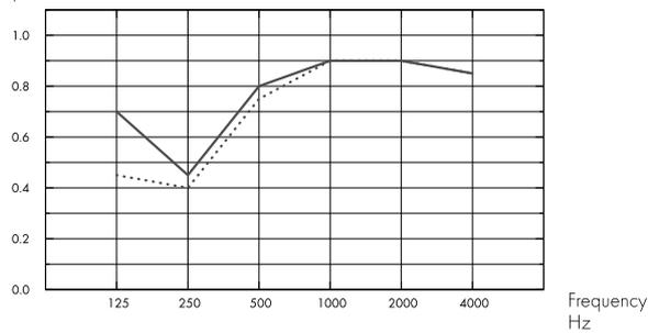
... Performance Baffle dispuestos en filas, c600 mm, con ~1,4 baffles/m<sup>2</sup> de techo, 600 mm g.t.s.
